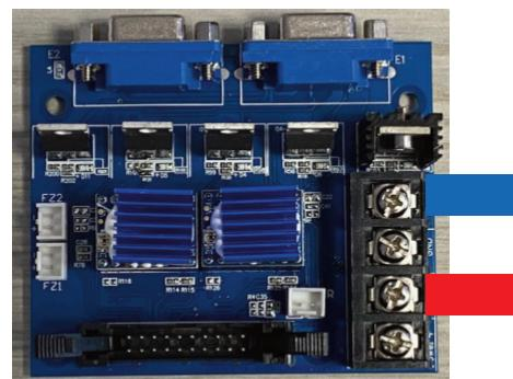
4/ trouvez ce câble et connectez le à la phase de l'alimentation de la machine et reliez le à la borne "1" du relais ... la position du relais à une importance pour l'implantation du projet ... Respectez SVP ce sens, à savoir les bornes 1 & 2 côté droit de la machine lorsque vous regardez l'intérieur de la machine ...
